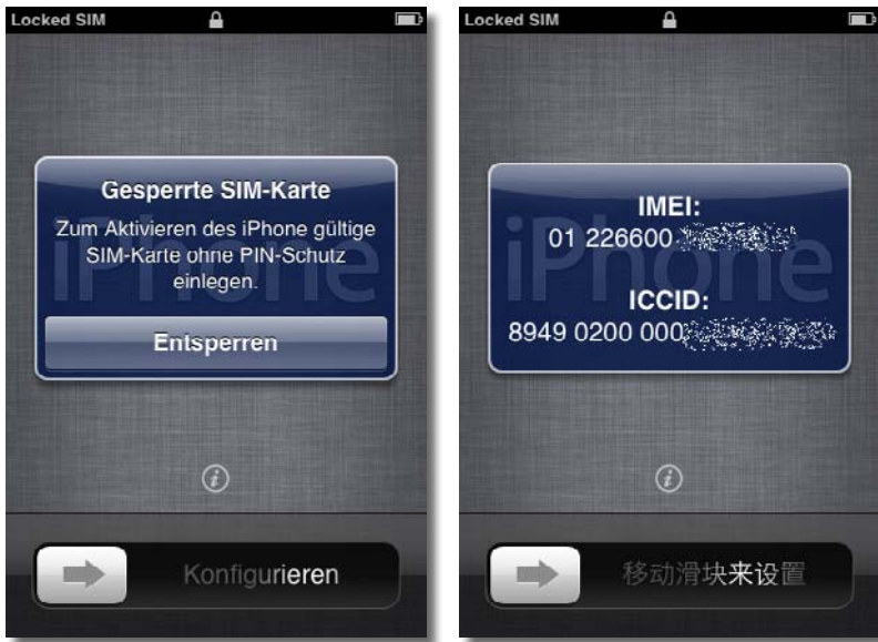
In diesem Fall ist Ihre SIM-Karte durch eine PIN gesperrt (links). IMEI und ICCID bezeichnen eindeutig Ihr Smartphone und Ihre SIM-Karte (rechts).
